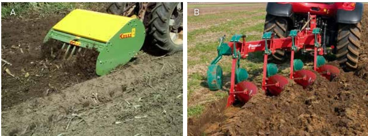
Figure 2 — Labour à la rotobèche (a) et labour à la charrue à socs (b)
