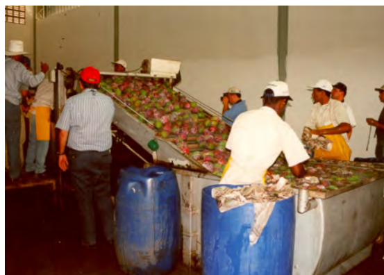
Figure 46 : Convoyeur autochargeur mécanique
