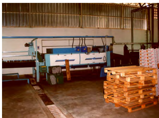
Figure 52 : Bac de trempage des fruits dans de l'eau chaude contenant un fongicide (Photo : Jean-Yves Rey)
