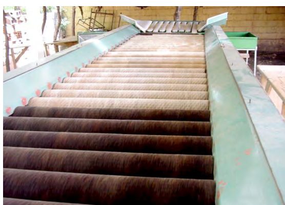
Figure 49 : Dispositif de brossage des fruits
