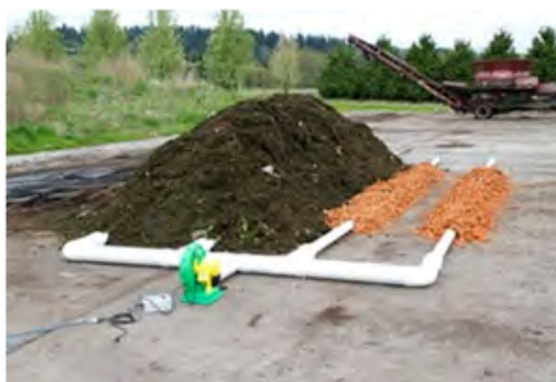
Figure 12 : Compostage en andain statique aéré (Power Knot)
