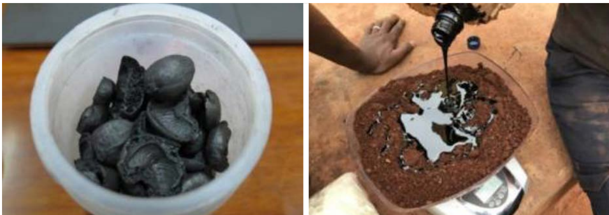
Figure 20 - Charbon de grande qualité produit à partir d'un carboniseur/four à charbon de bois
