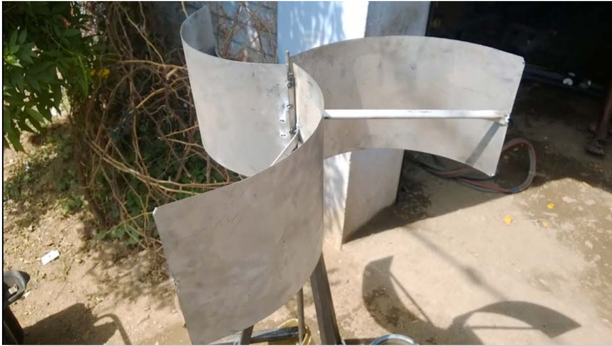
Figure 3 - Pompe à eau mécanique entraînée par le vent - projet de construction mécanique de pompes à eau éoliennes VAWT, 2013-2014
